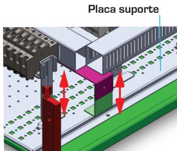
Os suportes para fixação dos componentes DIN são reguláveis no sentido da profundidade e o espaçamento entre eles também é regulável. Os cavaletes para fixação das canaletas plásticas são ajustáveis. A parte inferior do cavalete permite o ajuste para canaletas 100x100mm. Invertendo a fixação na placa suporte é possível a regulagem para as medidas menores.
