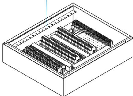
Para as caixas CW IP55/65 a montagem dos componentes deverá ser feita diretamente na placa suporte e, posteriormente, colocada no interior da caixa CW. Para facilitar a montagem da placa suporte no interior da caixa CW, em certos casos, é conveniente a remoção temporária dos perfis de fixação da porta/espelhos internos.
