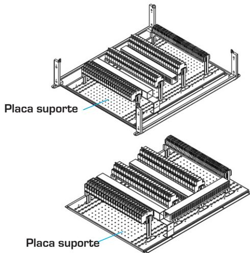
Para as Caixas CW IP 40, você pode efetuar a montagem dos componentes diretamente na estrutura da caixa ou na placa suporte e colocar, posteriormente, na estrutura. As laterais podem ser removidas para realização da montagem ou manutenção.
