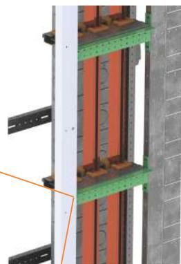
Fixação dos conjuntos de isoladores para fixação lateral coluna de distribuição 2A e 3A.
