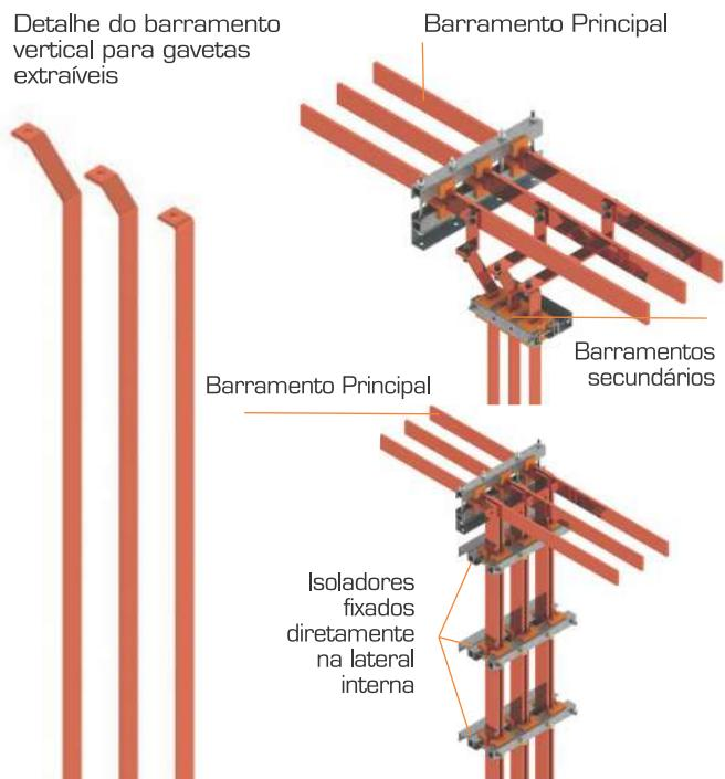
Detalhe de montagem do barramento dos compartimentos fixos
