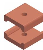
Detalhe de conexão do barramento das gavetas fixas
