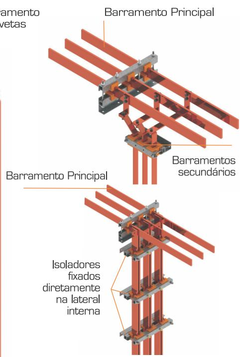
Detalhe de montagem do barramento dos compartimentos fixos
